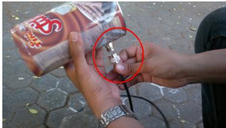
Gambar 15 : Kabel Pig tail pada Konektor N
