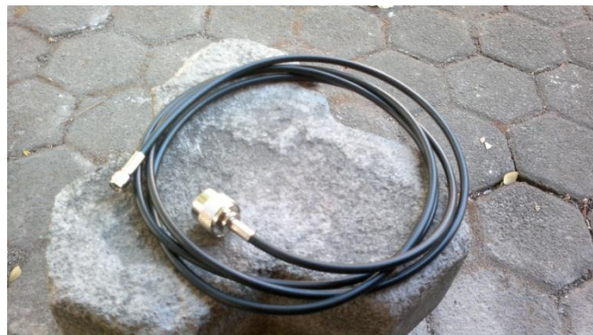
Gambar 10 : Kabel Pig Tail
